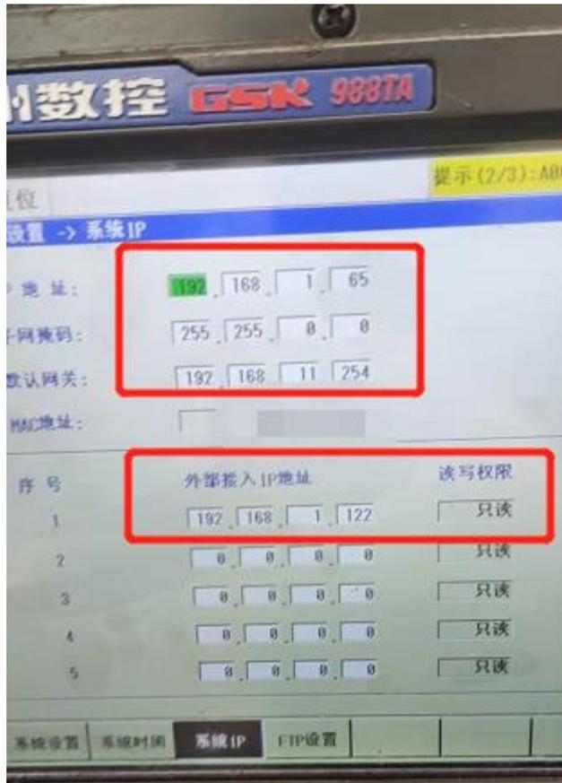
这里主要注意外部接入的 ip 地址为你的采集硬件（工控机、服务器、网关等）ip，读写权限一般为了避免风险都给到 只读 权限。
